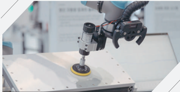
에이딘 피니싱 솔루션의 자동차 차체 표면 폴리싱 진행 예시
